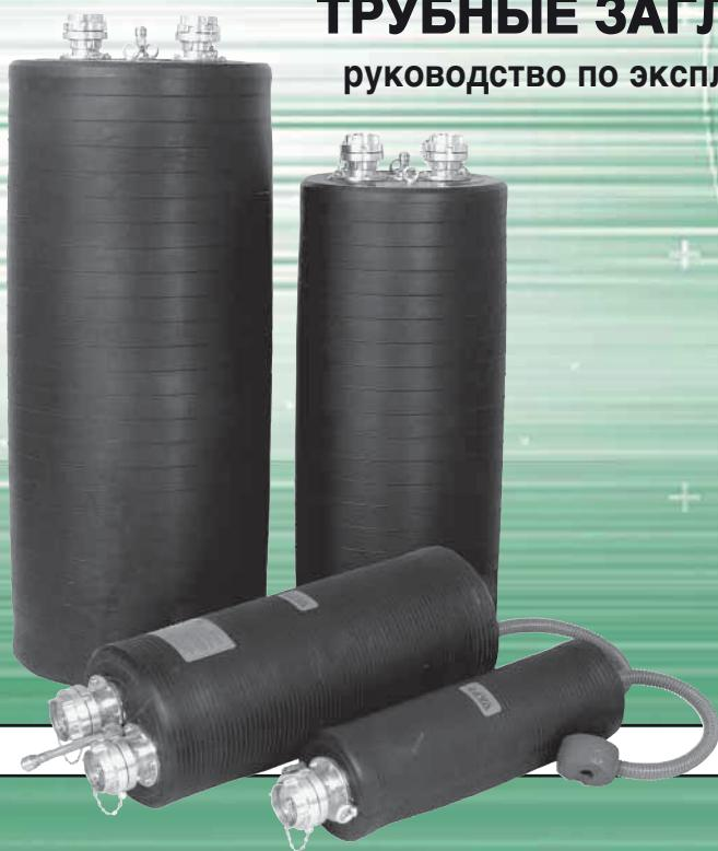
**Těsnicí vaky potrubí** jsou vyrobeny z kvalitní pryže, vyztužené polyamidovou nebo kevlarovou tkaninou. Kovové části jsou antikorozní. Každý vak je vybaven rychlospojkou pro nafukování a okem pro manipulaci a zajištění. Odolávají povětrnostním vlivům, teplotám od -30 °C do 80 °C, užitkové a odpadní vodě a jsou středně odolné chemikálím. Používají se hlavně při opravách, haváriích, údržbě a při zkouškách těsnosti potrubí vodou i vzduchem.
